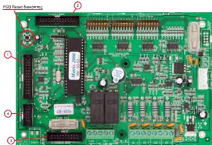
Σχήμα 16. Σημεία σύνδεσης της κύριας πλακέτας Matrix2000 με τα περιφερειακά
