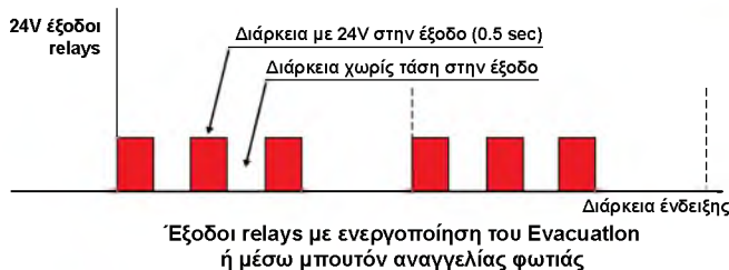
Σχήμα 18. Έξοδοι Relay με ενεργοποίηση του Evacuation ή μέσω μπουτόν αναγγελίας φωτιάς
